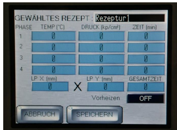
Grafische Touchpanel Oberfläche zur einfachen Eingabe und Verwaltung von Pressrezepten in der Steuerung.
